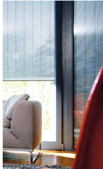
Der Rollladen besteht aus Lamellen aus extrudierter Aluminium-Legierung 6060 T5 mit den Abmessungen 9x10 und wird in allen RAL-Farben oder in verschiedenen Farben eloxiert geliefert; das Produkt hat eine lange Lebensdauer und ist ganz besonders robust; beim vollständigen Herunterlassen der Lamellen beträgt die Gesamtdicke des Aluminiums mehr als 3,3 mm, wodurch ein maximaler Schutz sichergestellt wird.
